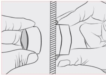
将操作头部由面板前方插入安装孔，于面板后旋入中座，然后均匀拧紧两端紧固螺钉（不可用力过猛，最大扭力 0.25N.m），如面板为塑料等其他非金属材料，可在面板后垫上一块安装板（见附件 F5）后再安装，如安装孔的直径为 25mm 时，可在面板后垫上一块  $\varnothing 25$  的安装板（见附件 F6）后再安装。
