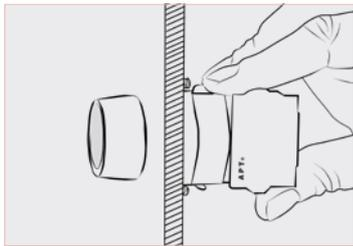
开关元件直接扣上即可，头部的符号片可直接在前部进行安装（一般在出厂时已装好）。如安装带灯按钮时，即先扣上灯座，然后再扣上开关元件。
