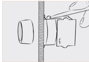
拆除开关元件或灯座：用螺丝刀抬起锁扣安装系统的搭扣，即可随意简便地拆卸已紧固安装的组件。
